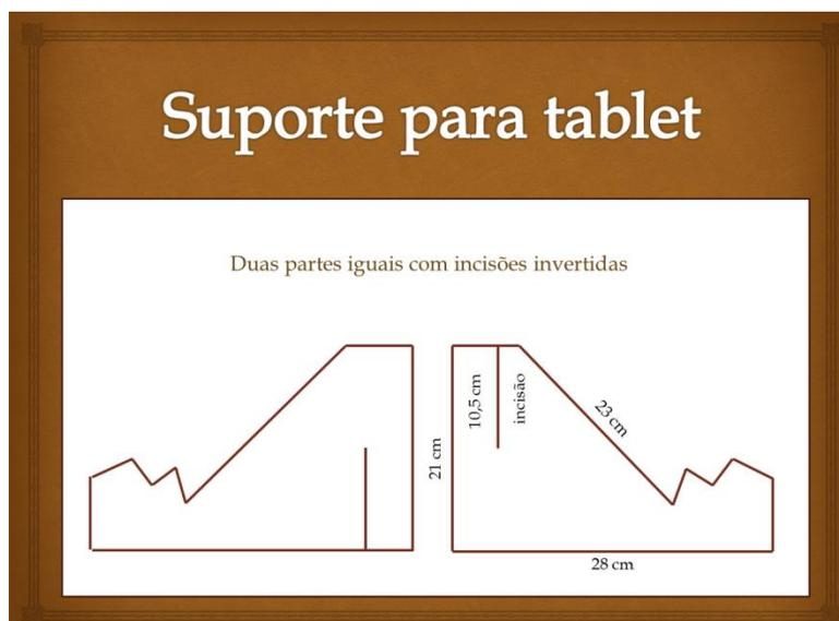
Ilustração 9 - Modelo 3 - Panificação e dimensões
