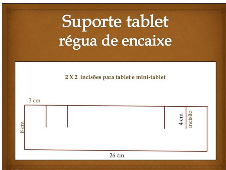
Ilustração 7 - Modelo 2 - Dimensões da régua
