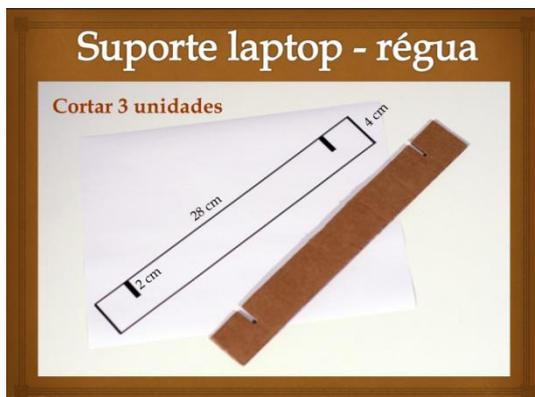
Ilustração 3 - Modelo 1 - Dimensões da régua
