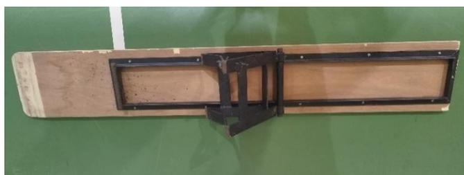
Baloço - Arranjar a tábua do baloço de bicicletas, conforme se pode verificar na imagem, do lado direito da mesma, falta uma parte. A parte direita deverá ter menos 3/4 cm que a esquerda para inclinar sempre para o mesmo lado – material em contraplacado marítimo. A entrada da passagem deve ser a mais baixa possível (com pequena rampa).
