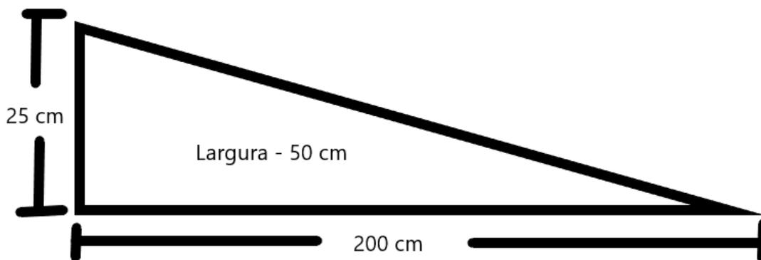
Rampa de saltos de bicicleta com tacos de borracha (pneu de automóvel) no plano inferior para ter aderência com o solo – material em contraplacado marítimo.
