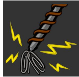
Ilustração 12 - Parafuso a atrair clips metálicos
