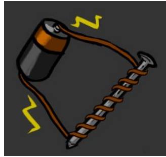
Ilustração 11 - Parafuso com fio ligado à pilha
