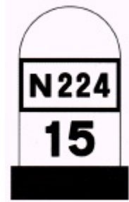
O2d – Demarcação quilométrica da via – restantes estradas
