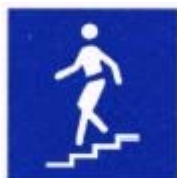
2.24 - Passagem desnívelada para peões com escada
