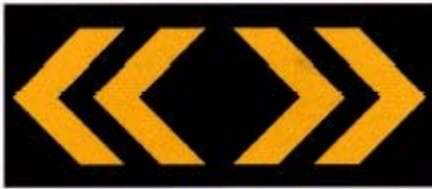
O5a – Baia direccional para balizamento de pontos de divergência
