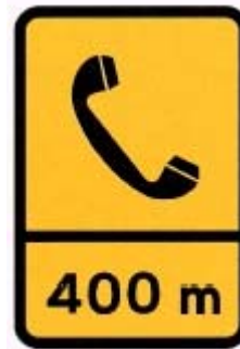
ST12 - Telefone de emergência
