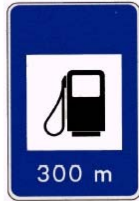
H13a – Posto de abastecimento de combustível
