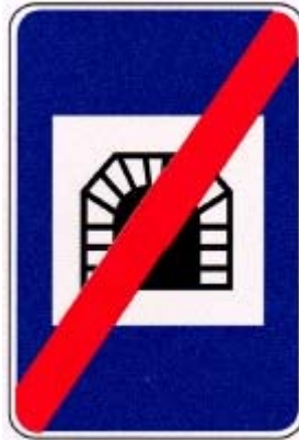
H41 – Fim de túnel
