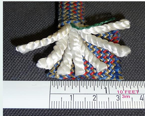
A **“CAMISA”** tem como função principal proteger a alma de agressões mecânicas e sujidade. A **“ALMA”**, que é constituída diversos filamentos, tem como função, garantir resistência e flexibilidade da corda.
